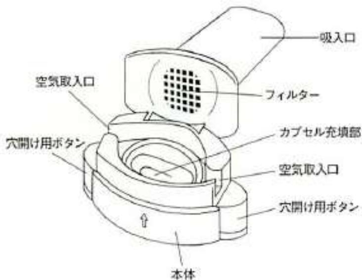
カプセルをカプセル充填部に入れ、穴あけ用ボタン(針)を押して穴を開けるカプセルが吸気によって吸い上げられ、カプセルが回転して薬剤が放出される
